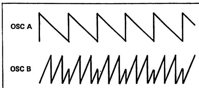
FIGURE 2-3 SYNCHRONIZATION OF OSCILLATOR B TO OSCILLATOR A
