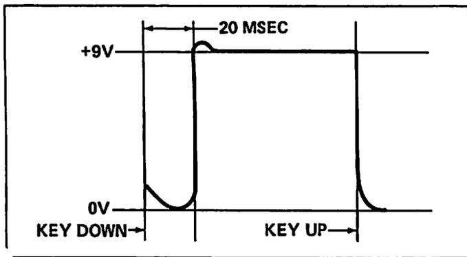
FIGURE 4-4 TRIGGER AT COLLECTOR OF Q8
